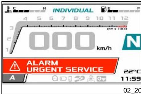
Si durante el encendido se verifica un fallo en el inmovilizador, en el tablero aparecerá una leyenda que solicita ingresar el código del usuario. Si se ingresa el código correctamente, el tablero indica la anomalía visualizando el mensaje SERVICE y encendiendo el testigo rojo de alarma general.
