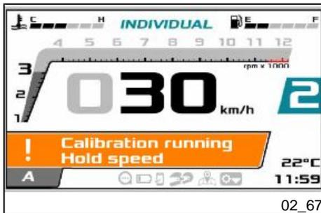
Para calibrar el sistema a-PRC (Aprilia Performance Ride Control), recorrer durante unos 10 segundos un tramo de carretera llano y rectilíneo, en segunda marcha, a una velocidad de 30 +/- 2 km/h (18.64 +/- 1.24 mph).
