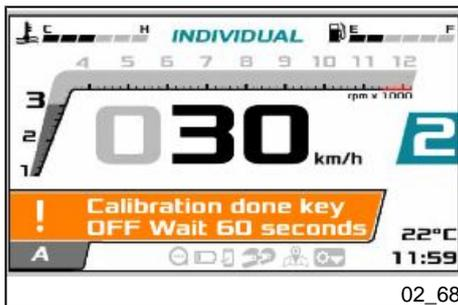
Si la calibración finaliza correctamente, se mostrará el mensaje "Calibration done Key OFF Wait 60 seconds".
